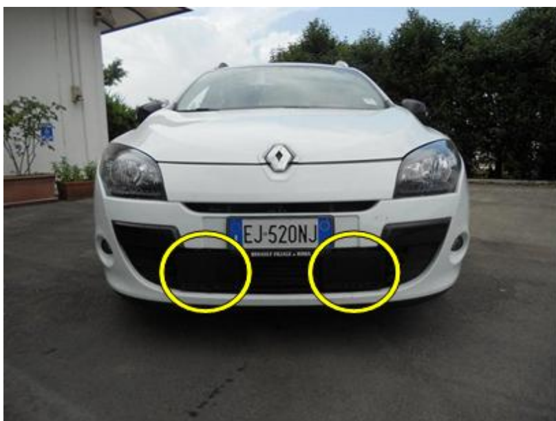
Immagine del sistema di illuminazione all'infrarosso incassato nel fascione frontale
